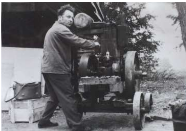
Oprava a sestavení agregátu na elektrické osvětlení.
